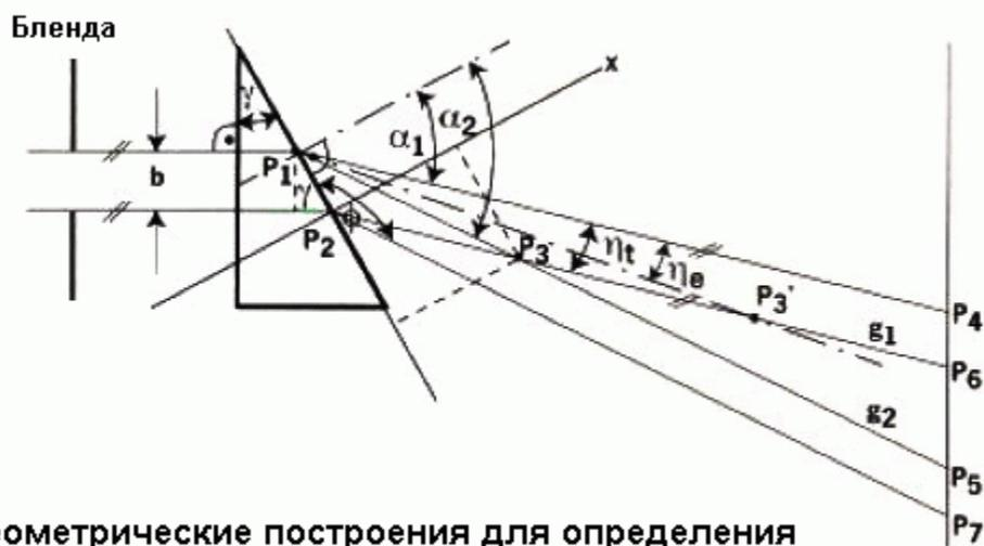
**Рис.5** геометрические построения для определения местоположения точки P3
